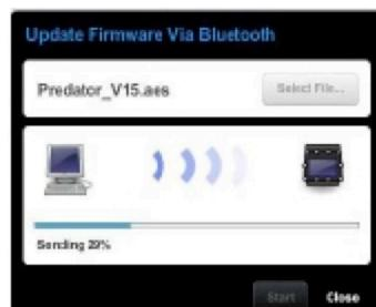
回到桌面控制软件(Shearwater Desktop)，点击更新固件("Update Firmware Box")或下载记录("Download Log."), 电脑开始连接Petrel并发送新固件。
