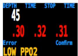
当使用手动密闭循环呼吸器及低氧分压稀释气体进行潜水时，
