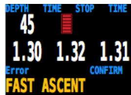
右图的警报信息提示潜水员已经超越电脑要求的停留深度超过一分钟。超越系统要求的停留深度的警报信息在一次潜水中仅会显示一次，但是在潜水员返回水面后，本警报信息还会重复显示一次。
