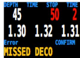
右图的警报信息提示所有组织内气体余量信息已经清除。此时所有的减压相关信息也被清除。
