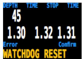
固件升级后重启电脑会看到右图的警报信息。在升级固件后重启电脑，屏幕显示本信息属于正常现象。
