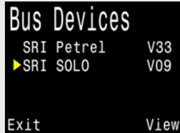
“Bus Devices (버스 장치)” 페이지에서, “View (보기)”를 선택하여 자세한 정보와 설정 확인 가능
