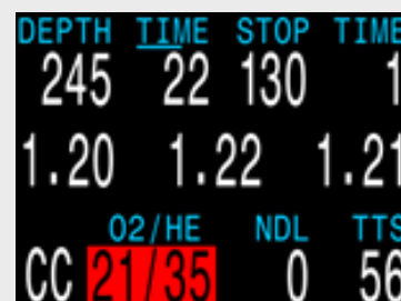
Il diluente del CC diventa rosso per indicare che non è sicuro respirarlo direttamente (PPO 2 > 1.60)
