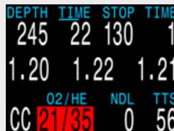
直接呼吸するのは危険であることを示すために (PP02 > 1.60)、CC ディリユエントが赤くなります
