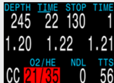
CC 희석 기체가 빨간색일 경우 직접적으로 호흡하기 위험함을 나타냄 (PPO2 > 1.60)
