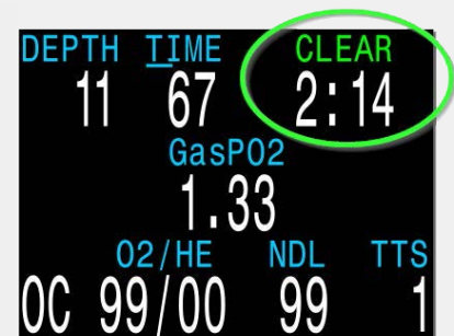
El Clear Counter (Cont. descomp. real.) comienza a contar desde cero una vez que realizó las paradas de descompresión.
