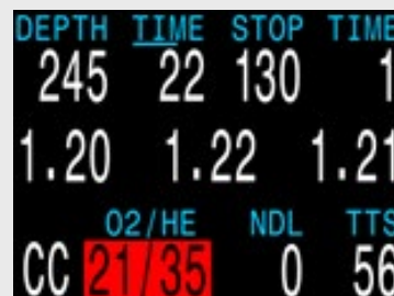
密闭系统的稀释气体显示为红色代表直接呼吸并不安全（氧分压 >1.60）
