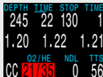
O diluente do CC fica vermelho para indicar que não é seguro respirar diretamente (PPO2 > 1,60)
