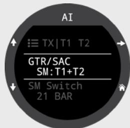
Aggiunta di un'opzione di visualizzazione della durata residua ridondante (Redundant Time Remaining, RTR). Si tratta della GTR calcolata solo sulla bombola con la pressione inferiore (cioè la GTR se si dovesse perdere la bombola con la pressione maggiore).
