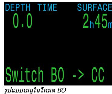
การเลือกนี้จะแสดงเป็น "Switch CC > BO" หรือ "Switch BO > CC" โดยขึ้นอยู่กับการตั้งค่าปัจจุบันของนาฬิกาดำน้ำ
