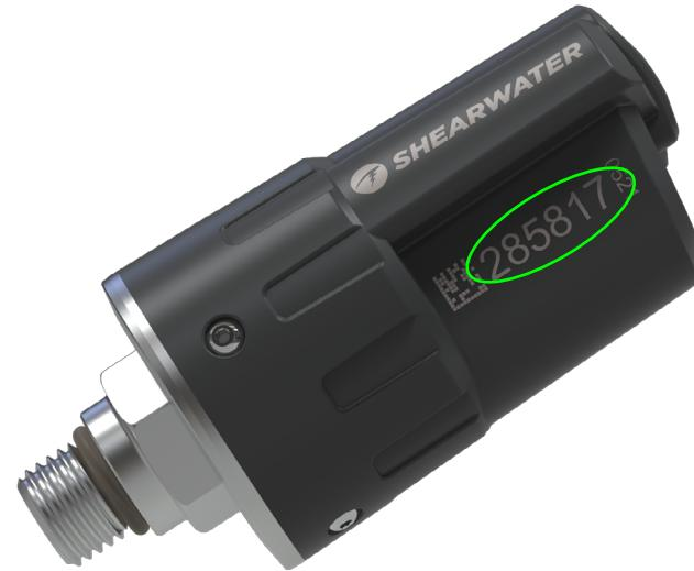
จับคู่เครื่องส่งสัญญาณนี้โดยการไปที่ตัวเลือกเมนู **Tx Setup** และเลือก T1 เปิด T1 จากนั้นป้อนหมายเลขเครื่องส่งสัญญาณ 6 หลักในการตั้งค่า **T1 Serial #** คุณต้องตั้งค่าเพียงครั้งเดียวเท่านั้น จากนั้นจะบันทึกไว้อย่างถาวรในหน่วยความจำการตั้งค่า
