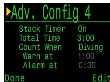
สามารถเปิดปิดได้ที่เมนู Advanced Config 4 (การกำหนดค่าขั้นสูง 4) สามารถตั้งเวลารวมตั้งแต่ 1 ชม. จนถึง 9 ชม. 59 นาที สามารถตั้ง Stack Timer ให้นับถอยหลังขณะดำเนินการหรือเมื่อเปิดนาฬิกาดำเนินการ ค่าเดือนจะแจ้งเตือนนักดำเนิน เมื่อ Stack Timer เหลือเวลา 1 ชม. และจะมีสัญญาณเตือนปรากฏ เมื่อ Stack Timer เหลือเวลา 30 นาที
