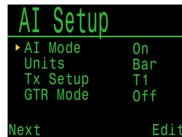
เมื่อ **AI Mode (โนมด AI)** ได้รับการตั้งค่าเป็น **Off (ปิด)** ระบบย่อ AI จะปิดการทำงานทั้งหมดและจะไม่ใช้พลังงานใด ๆ เมื่อเปิดใช้งาน ระบบ AI จะเพิ่มอัตราการใช้พลังงานประมาณ 10%
