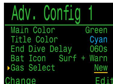
在高級1中將氣體選擇設置為「全新」以使用全新風格的氣體設定功能表
