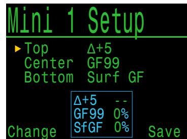
迷你顯示區可同時顯示多達9個可自訂的字段，還有可自訂的中間區域和迷你NDL的替代選項。若設置不當，可能顯示過量資訊。
